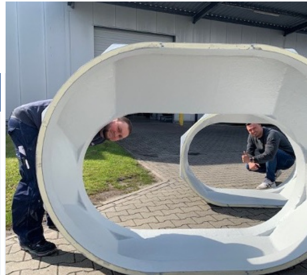
Stolz präsentieren unsere Techniker ihre „Riesenbabys“: individuell angefertigte Sonderbauteile, in diesem Fall Reduzierungen verschiedener Durchmesser
