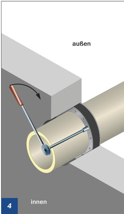
Die Spannmutter mit Drehmomentschlüssel von innen anziehen.
