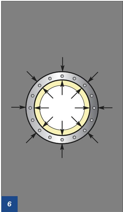
Abschließende Sichtkontrolle, ob die Ringraumdichtung umlaufend an der Leitung und an der Kernbohrung/der LAVANTUS® erdverlegten Luftleitung anliegt.
