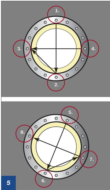
Die Spannmutter im Wechsel über Kreuz jeweils einige Umdrehungen anziehen.
