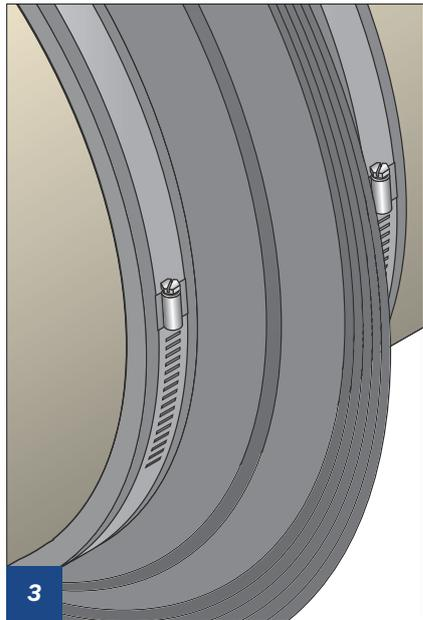
Den Mauerkragen mit den beiden Spannringen auf die LAVANTUS® Luftleitung schieben.
