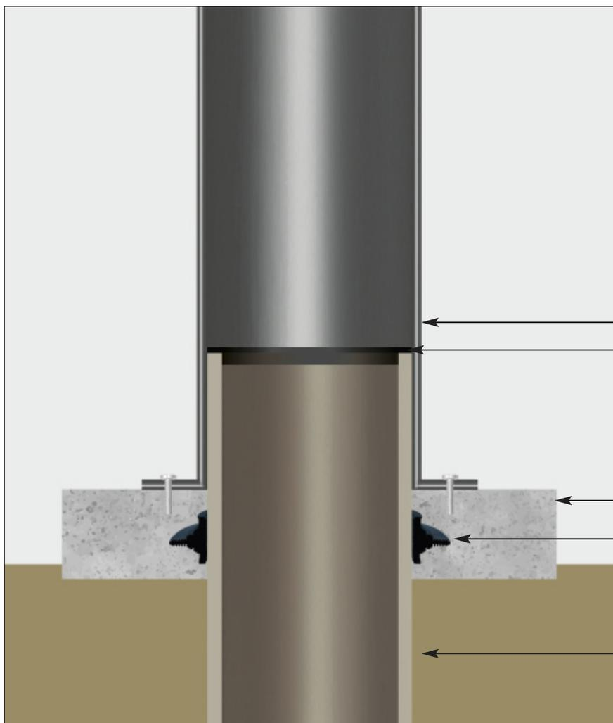
Bei Lüftungstürmen gibt es verschiedene Möglichkeiten, eine Luftleitung anzuschließen. Die exemplarische Darstellung zeigt die Montage der LAVANTUS® Luftleitung an einen Lüftungsturm, indem sie durch einen Mauerkragen im Bodensockel geführt wird (s. Montageanleitung Mauerkragen). In diesem Beispiel wird der Lüftungsturm über das herausstehende Ende der Luftleitung aufgesetzt und auf dem Bodensockel befestigt.
