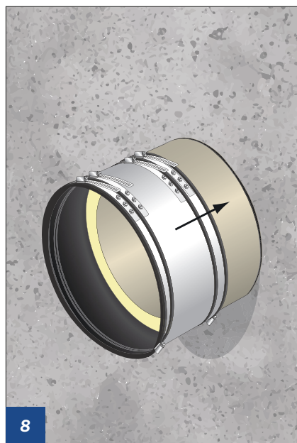
Verschaltung und Endstopfen entfernen, danach LavantusGrip-Manschette auf Leitung aufschieben (siehe S. 5.20).
